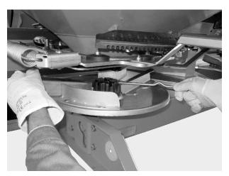
Fig. 27: Loosen the cap nut
