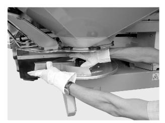
Fig. 28: Unscrew the cap nut
