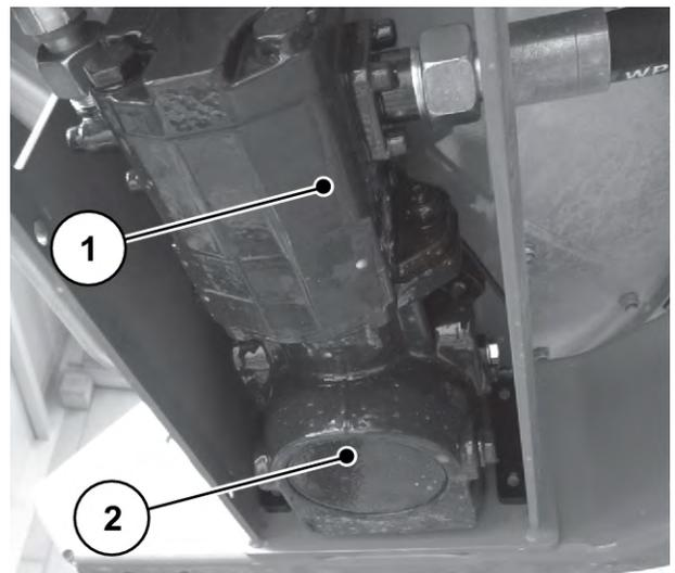
*Fig. 65: Moteur hydraulique*
