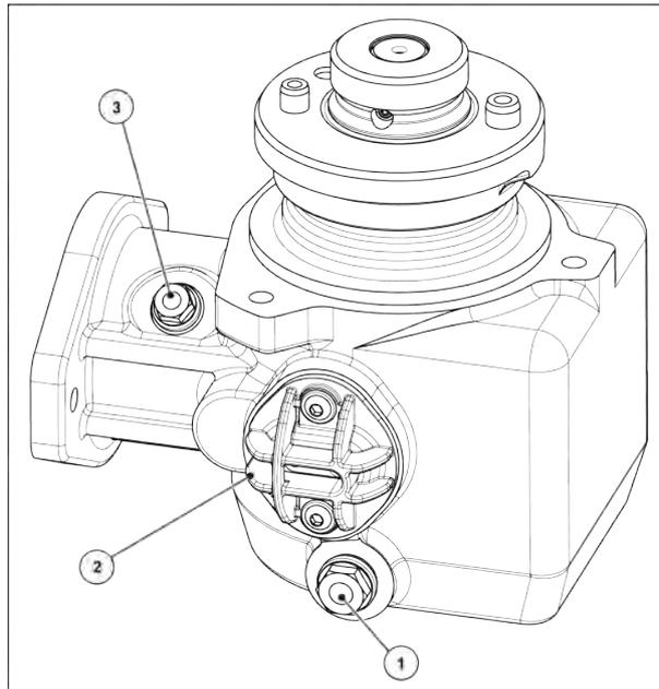
Fig. 67: Point de remplissage et de vidange de l'huile de graissage
