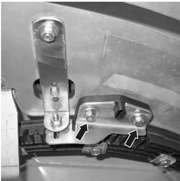
*Fig. 62: desserrer la tôle d'ajustage du point de chute*
