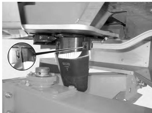
Fig. 37: Attacher la goulotte du contrôle de débit
