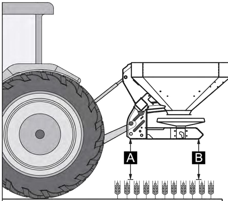
Fig. 15: Position et hauteur d'attelage en épandage normal
