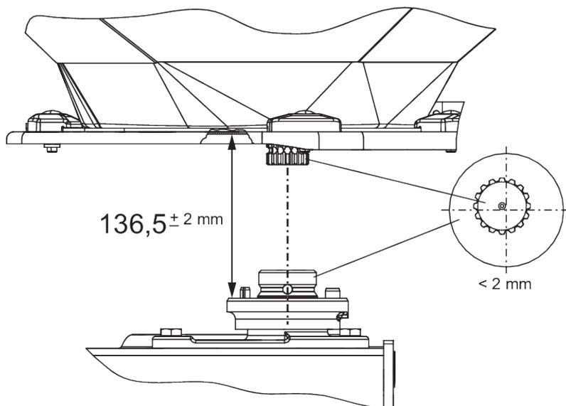
Fig. 52: Vérifier la position du moyeu du disque d'épandage
