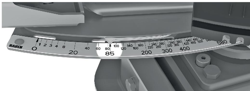
Fig. 25: Échelle graduée indiquant la dose d'épandage
