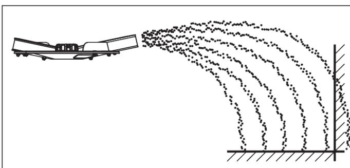
Fig. 20: Épandage en bordure rendement en épandage normal
