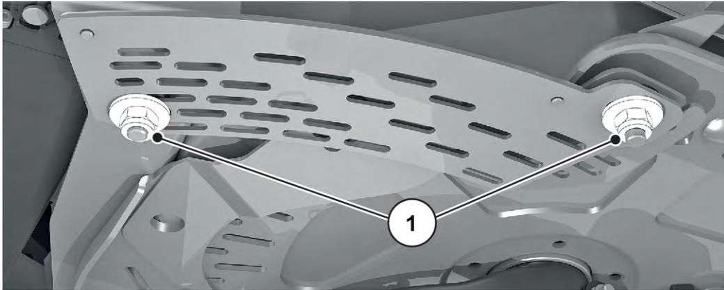
Fig. 59: Vis de fixation du secteur gradué
