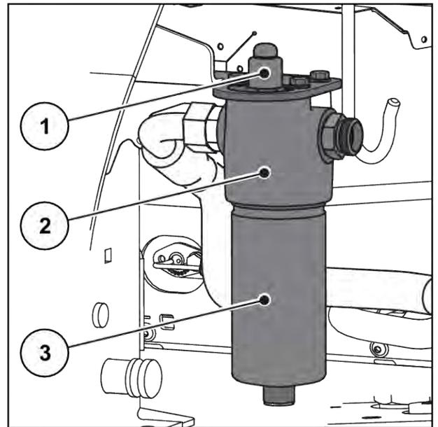
Fig. 66: Filtre à pression hydraulique
