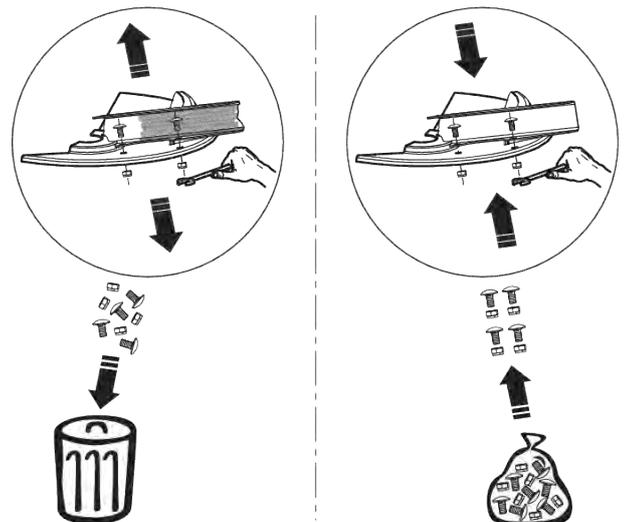
Fig. 57: Utiliser de nouveaux écrous autobloquants
