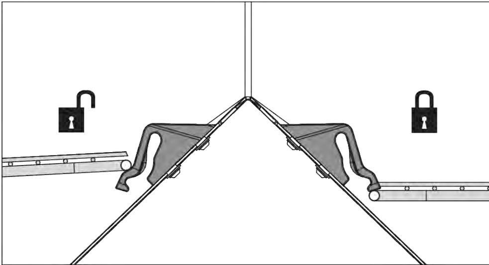
Fig. 48: Blocage de la grille de protection ouvert/fermé
