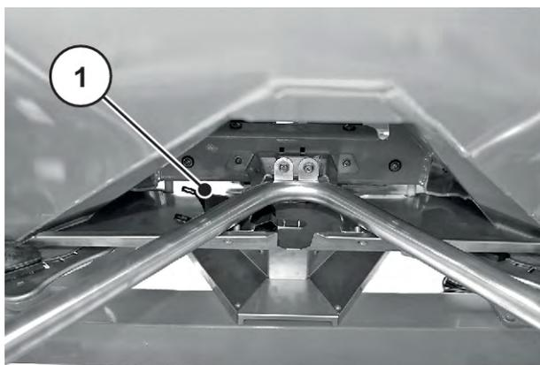
Fig. 35: Glissoir de test d'épandage
