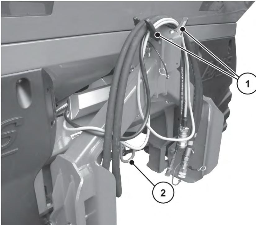
Fig. 40: Rangement des câbles et des tuyaux hydrauliques
