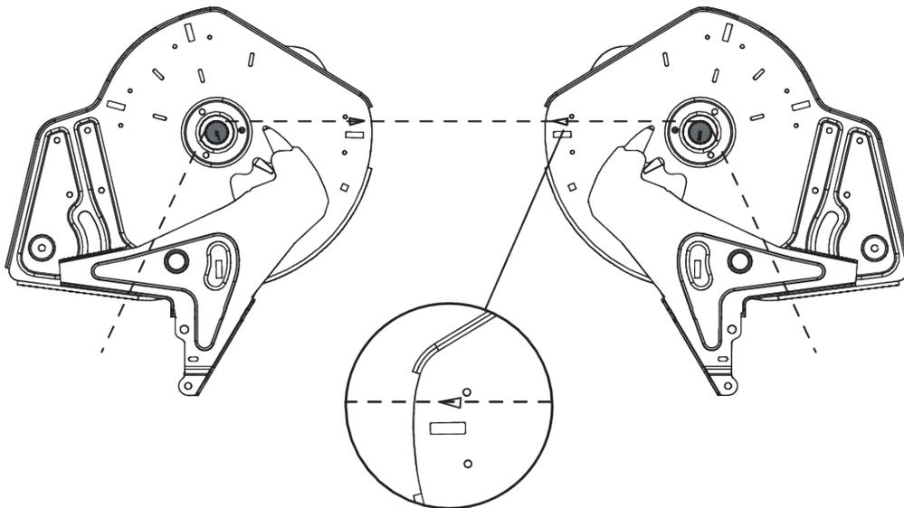
Fig. 61: Vérifier le réglage du point de chute
