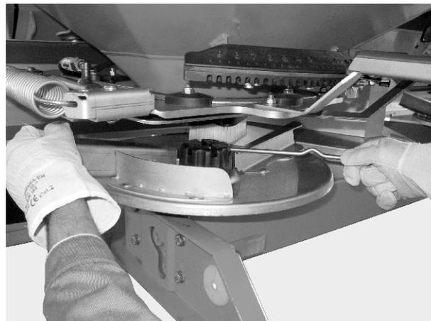
Fig. 36: Desserrer l'écrou borgne
