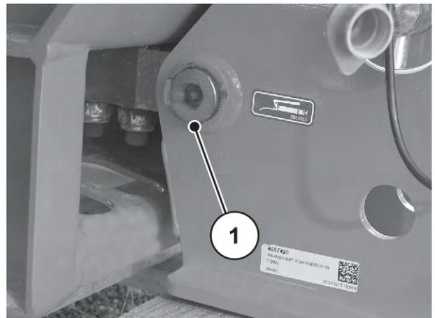
Fig. 64: Point de lubrification sur l'épandeur à pesée
