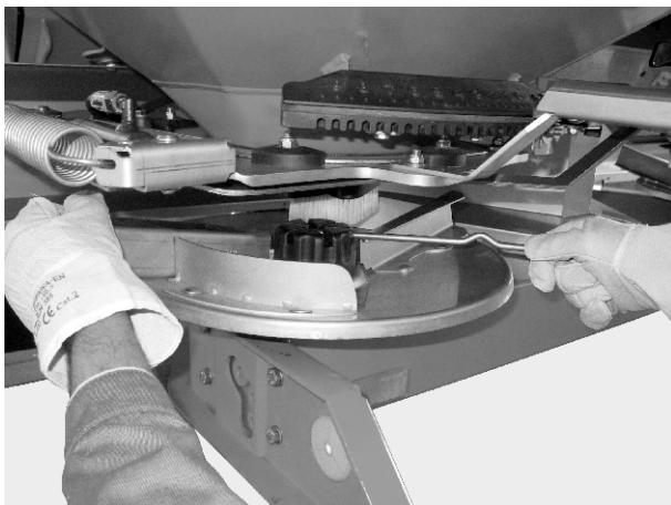
Fig. 36: Desserrer l'écrou borgne
