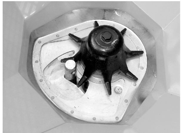
Abb. 58: Unterlenkerbolzen in Dosieröffnung
