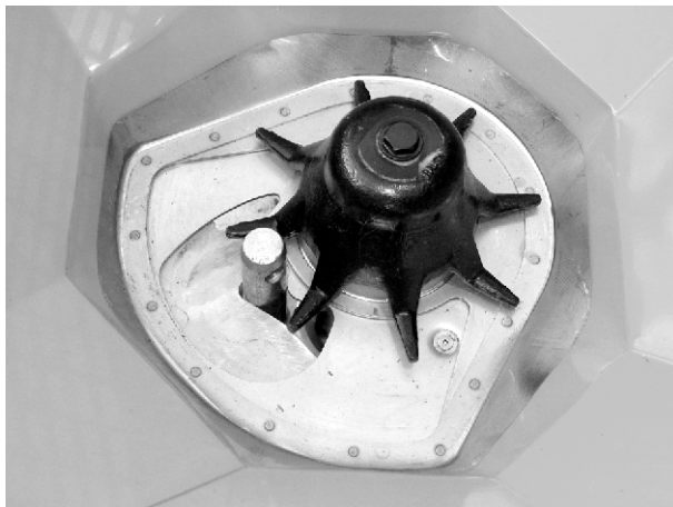
Abb. 58: Unterlenkerbolzen in Dosieröffnung
