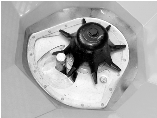
Ilust. 58: Pino do braço inferior na abertura de dosagem
