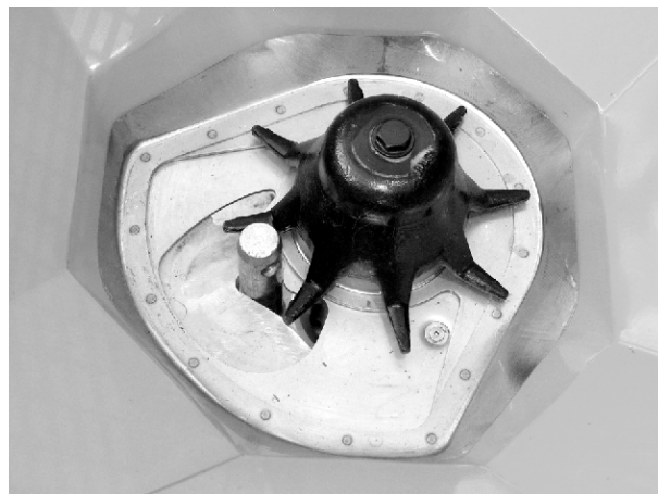
Mynd 59: Beislisbolti í skömmtunaropi
