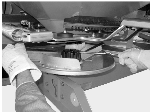
Mynd 37: Losað um hetturó
