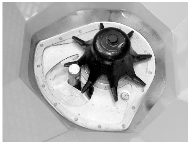
Mynd 59: Beislisbolti í skömmtunaropi
