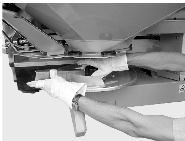
Sl. 40: Pritezanje zaobljene slijepne matice
