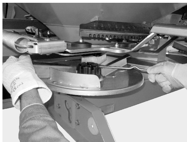
Sl. 28: Otpuštanje zaobljene slijepe matice
