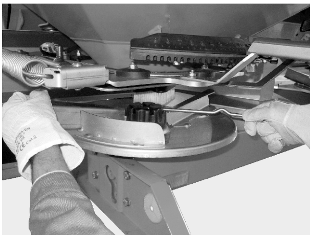
Sl. 37: Otpuštanje zaobljene slijepice matice
