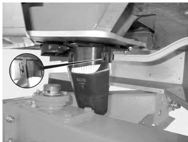
Рис. 38: Підвішування спускної труби для встановлення норми внесення добрива
