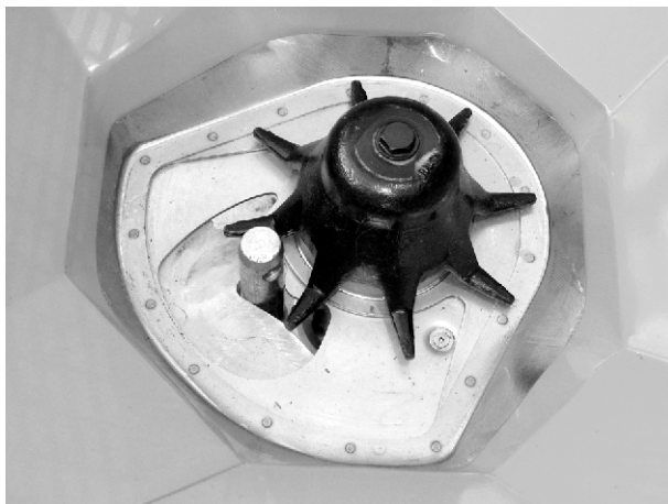
Рис. 59: Болт нижньої тяги в дозувальному отворі
