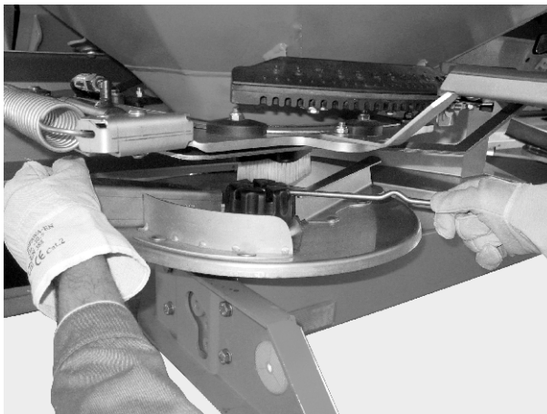
Σχ. 37: Χαλάρωση τυφλού παξιμαδιού
