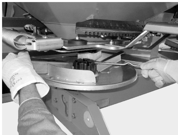
Att. 28: Kupoluzgriežņa atskrūvēšana
