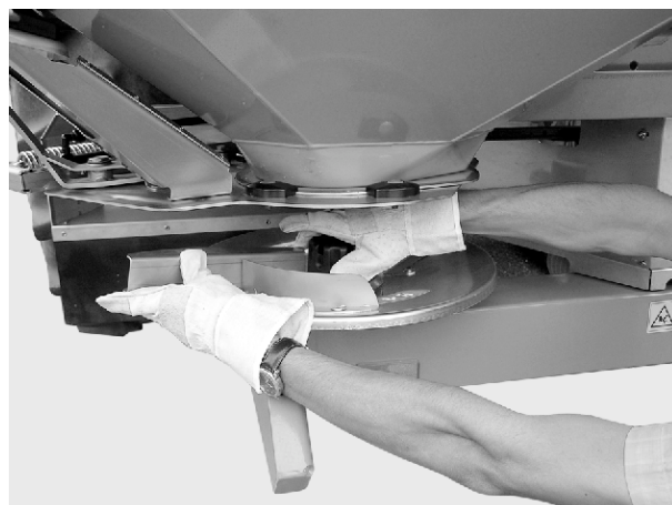
Att. 29: Kupoluzgriežņa noskrūvēšana
