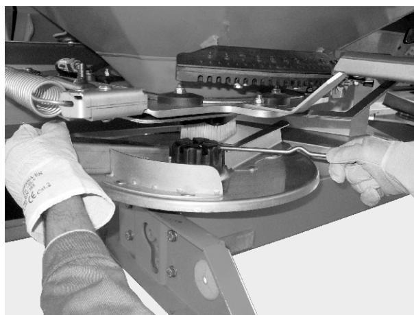
Pav. 28: Gaubiamosios veržlės atlaisvinimas
