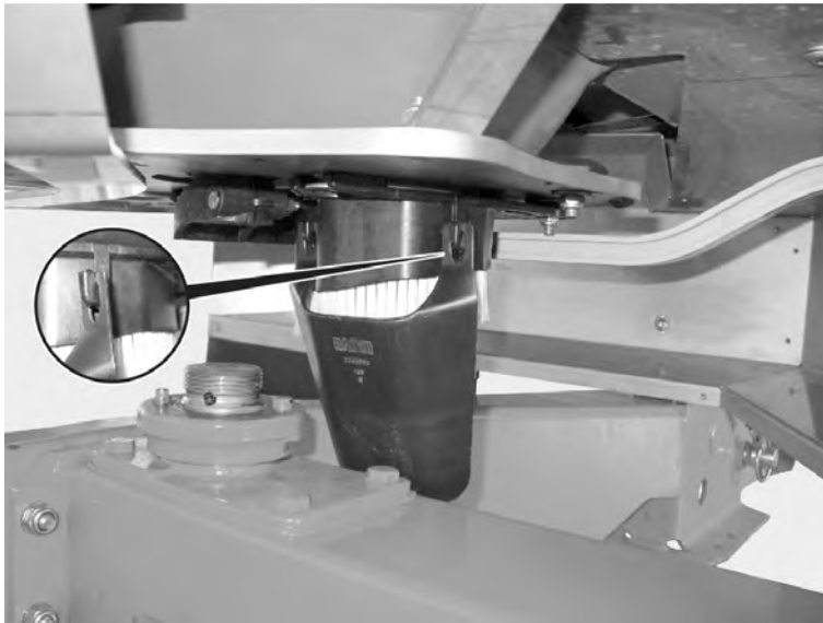
Obr. 38: Zavesenie sklzného žľabu na skúšobné rozmetávanie
