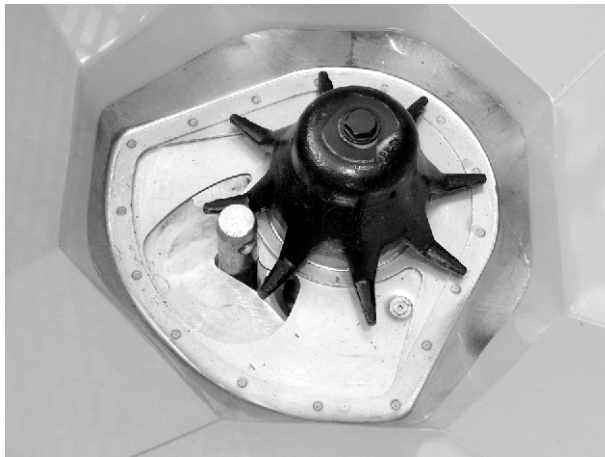
Фиг. 59: Болт на долния свързващ прът в дозирация отвор
