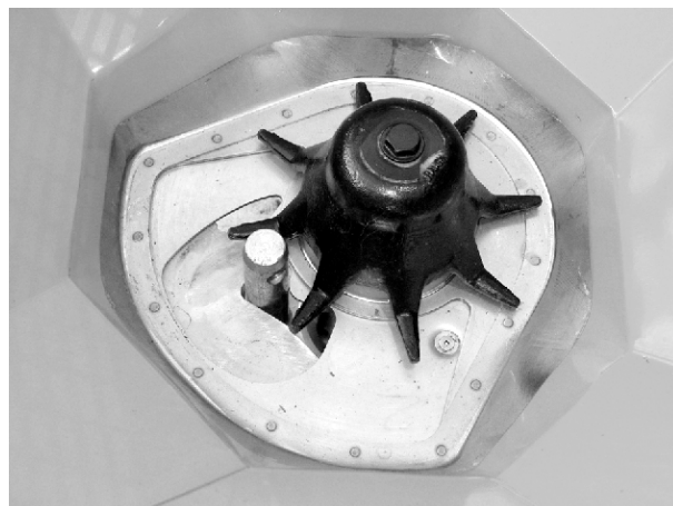
Fig. 59: Trekkstangbolt i doseringsåpning
