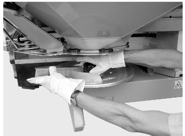
Fig. 29: Skru av hettemutter
