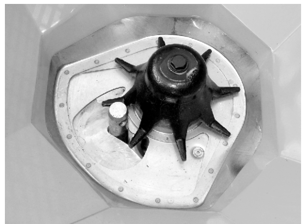
Ilust. 59: Perno de la barra de tiro en el orificio de dosificación
