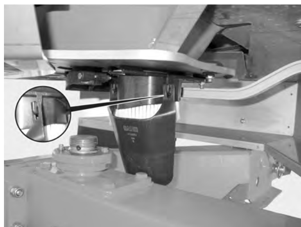
Ilust. 38: Enganchar el plano inclinado de prueba de giro
