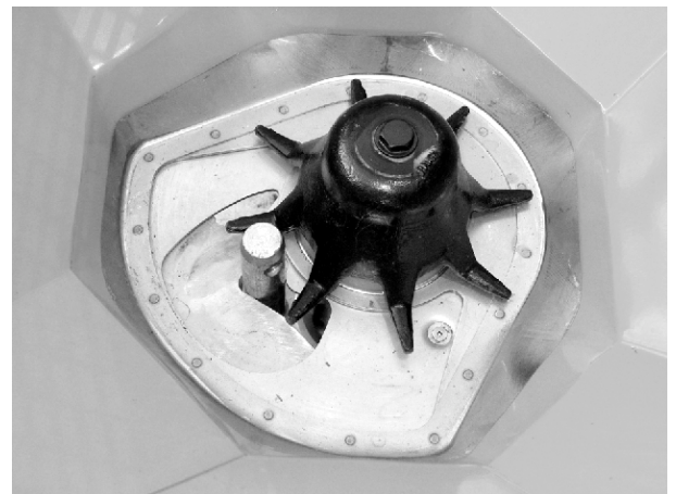
Ábr. 59: Alsó összekötőcsap az adagolónyílásban
