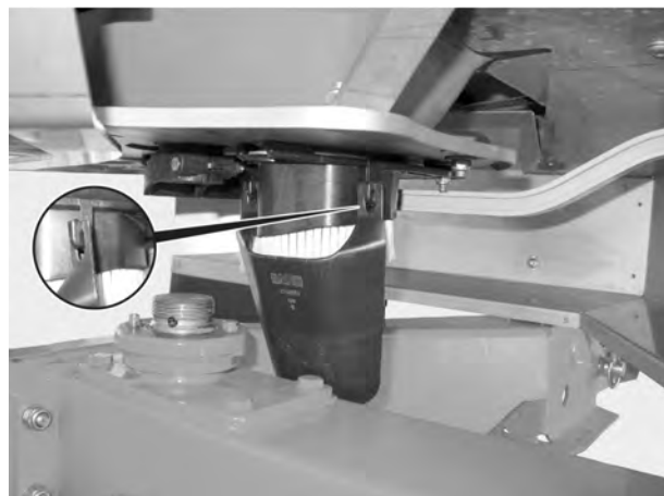
Ábr. 38: A leforgatási próba csúszdájának beakasztása
