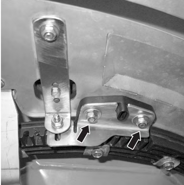
Ábr. 63: Feladási pont állítólemezeinek kioldása
