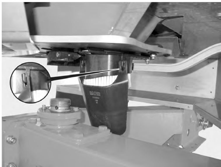
Afb. 38: Glijgoot voor de afdraairoef ophangen
