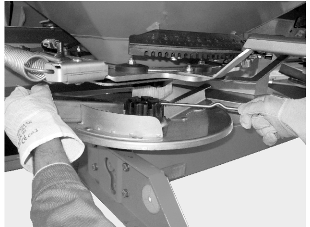
Fig. 28: Løsning af kalotmøtrikken
