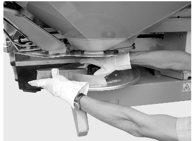
Fig. 29: Udskruining af kalotmøtrikken
