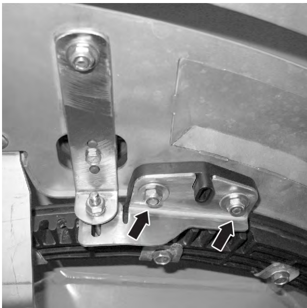
Fig. 63: Løsning af udbringningspunktets justeringsplade
