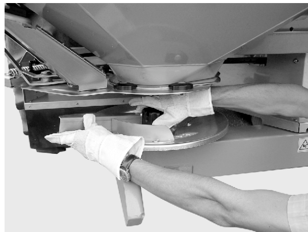
III. 29: Svitamento del dado a cappello
