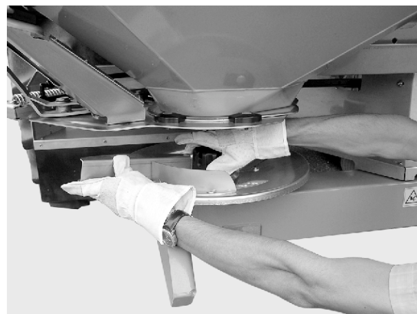
Fig. 29: Dévisser l'écrou borgne
