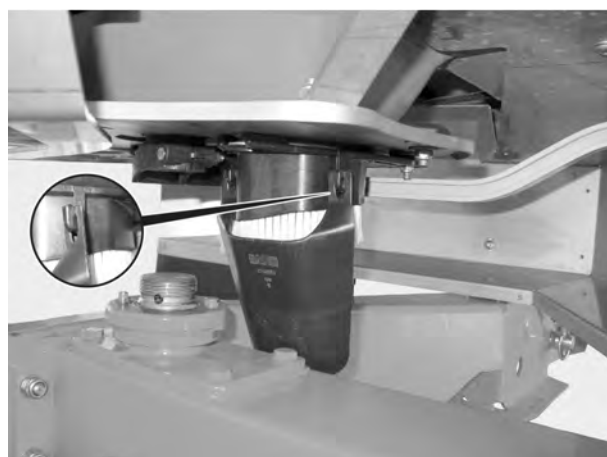
Fig. 38: Attacher la goulotte du contrôle de débit
