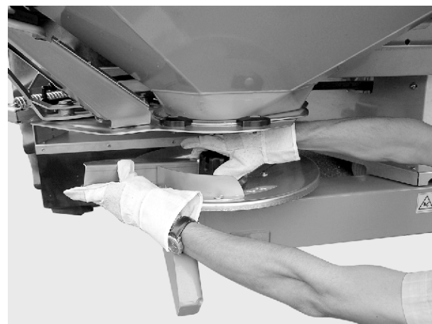
Fig. 29: Dévisser l'écrou borgne
