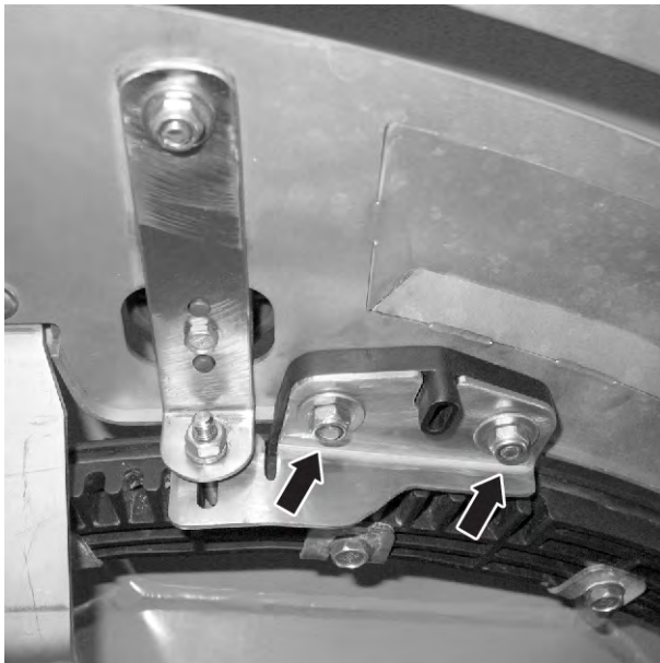
Fig. 63: desserrer la tôle d'ajustage du point de chute
