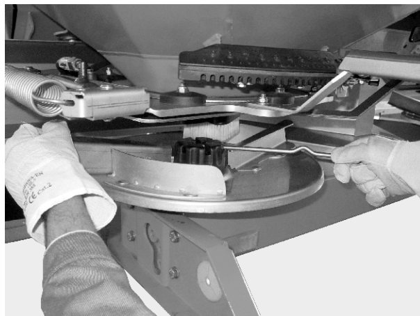
Fig. 37: Loosening the cap nut
