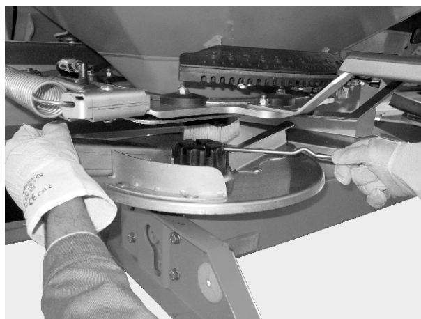
Fig. 28: Loosen the cap nut
