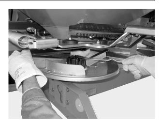
Fig. 37: Loosening the cap nut
