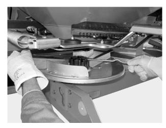
Fig. 28: Loosen the cap nut
