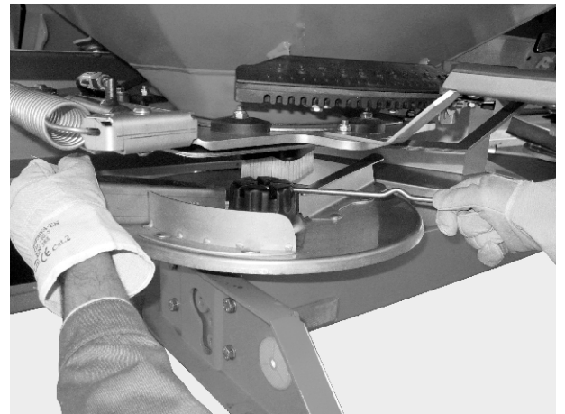
Fig. 28: Loosen the cap nut
