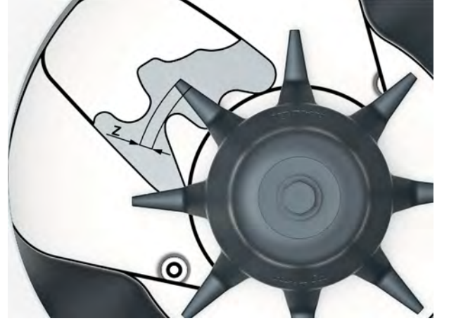
Şek. 55: Karıştırıcı kafasının aşınma bölgesi
