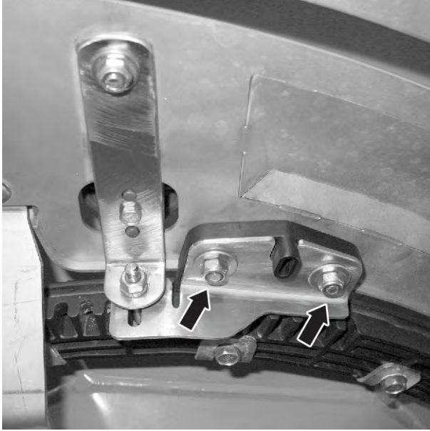
Şek. 63: Gübre verme noktası düzeltme levhasının sökülmesi
