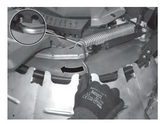
Fig. 37: Unhooking the return spring
