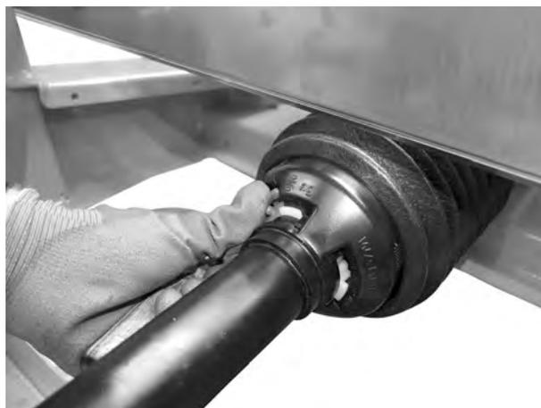
*Fig. 19: Bloquer la protection de l'arbre de transmission*
