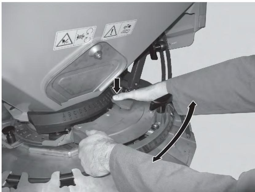
Fig. 28: Centre de réglage du point de chute
