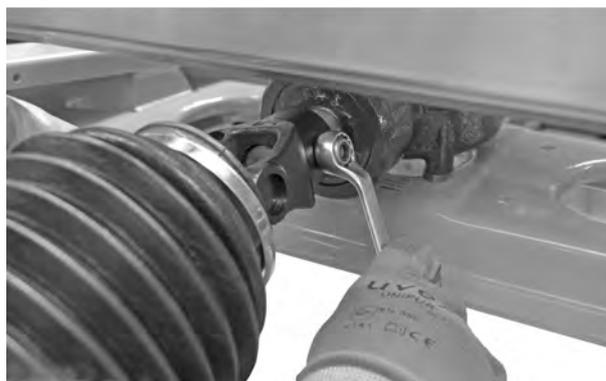
*Fig. 17: Raccordement de l'arbre de transmission*
