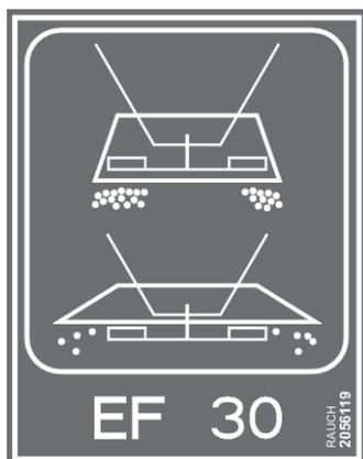
Fig. 23: Marquage des unités de commande pour la limitation de la largeur d'épandage.
