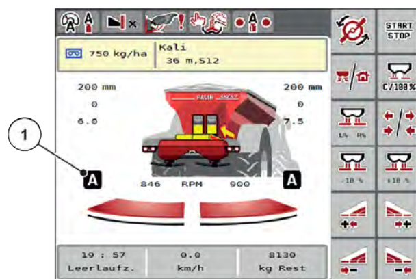
Obr. 46: Zobrazení rozmetacího provozu na provozní obrazovce s GPS Control
