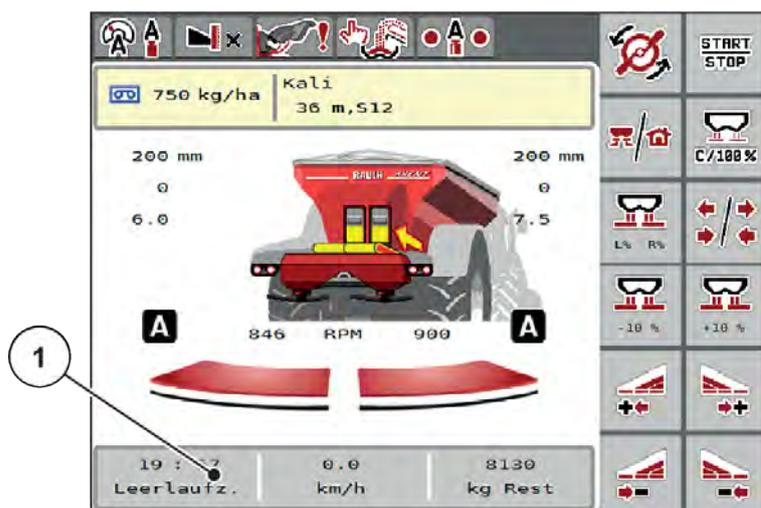
图 44: 在操作界面上显示空转测量
