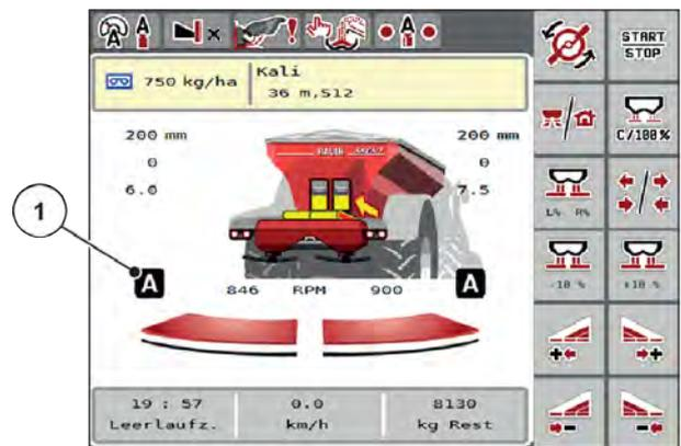
图 46: 在带 GPS 控制的操作界面上显示撒肥作业
