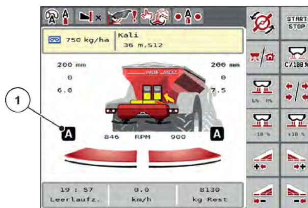
Ilust. 46: Indicación del modo de dispersión en la pantalla de funcionamiento con GPS Control
