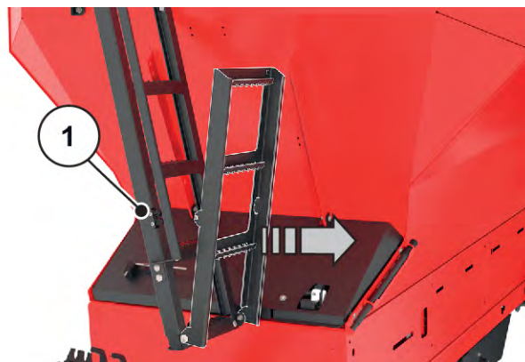
Rys. 35: Wysuwanie dolnej części drabiny
