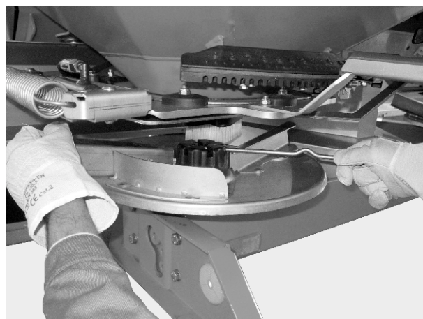
Rys. 42: Luzowanie nakrętki kołpakowej
