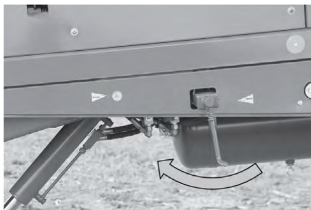
Рис. 49: Стоянкове гальмо (гідравлічна гальмівна система)
