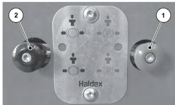
Рис. 48: Стоянкове гальмо (пневматична гальмівна система)
