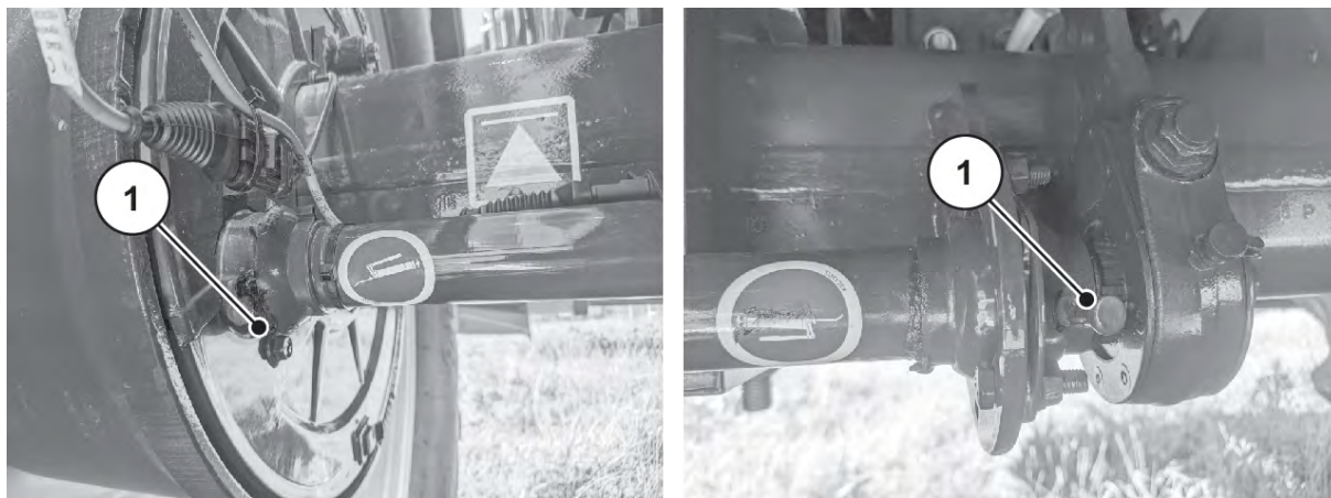
Рис. 61: Підшипник гальмівного валу нерухомої осі
