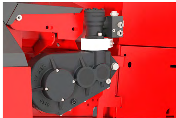
Рис. 66: Перевірка двигуна і гідравлічного блоку приводу транспортерної стрічки
