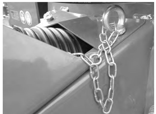
Рис. 22: Кріплення утримуючого ланцюга
