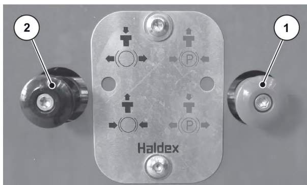
Рис. 30: Відпускання стоянкового гальма
