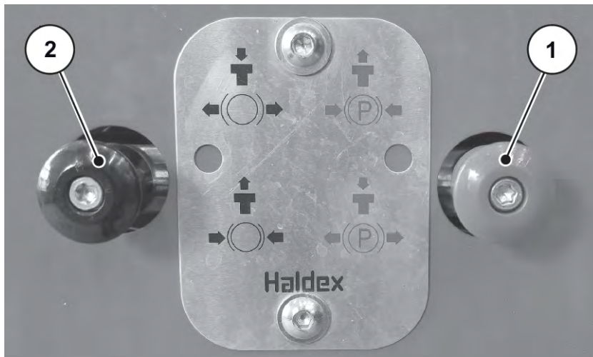
Рис. 46: Затягування ручного стоянкового гальма
