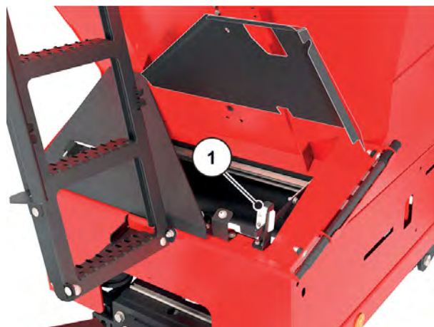
Obr. 34: Čistící klapka v zavřené poloze, ve směru jízdy dopředu
