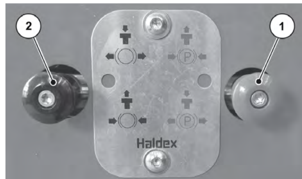
Obr. 32: Odbrzdění parkovací brzdy
