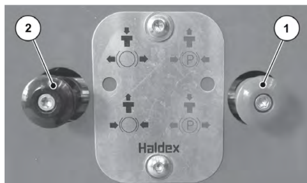
Obr. 48: Parkovacia brzda (pneumatické brzdivé zariadenie)
