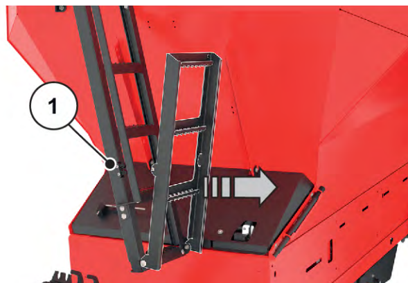
Obr. 35: Vyklopenie dolnej časti rebríka
