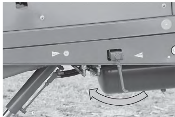
Obr. 49: Parkovacia brzda (hydraulické brzdivé zariadenie)
