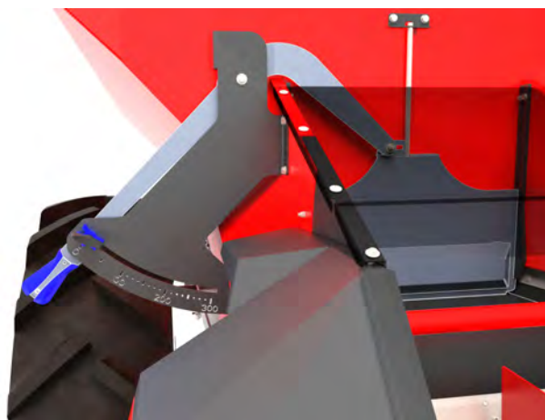
Obr. 33: Posúvač predbežného dávkovania v zatvorenej polohe
