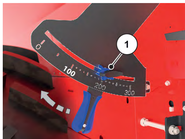
Fig. 37: Skalabue til fordoseringsspjæld-åbning
