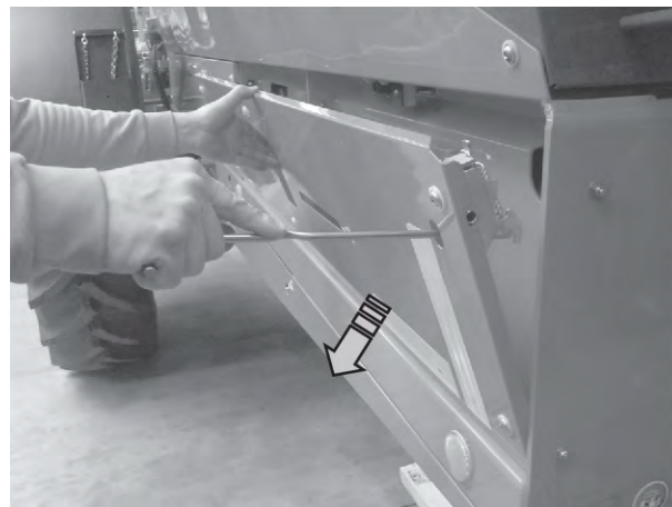
Fig. 56: Nedklapning af sideafdækningen
