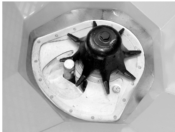
Fig. 95: Trækstangbolt i doseringsåbningen
