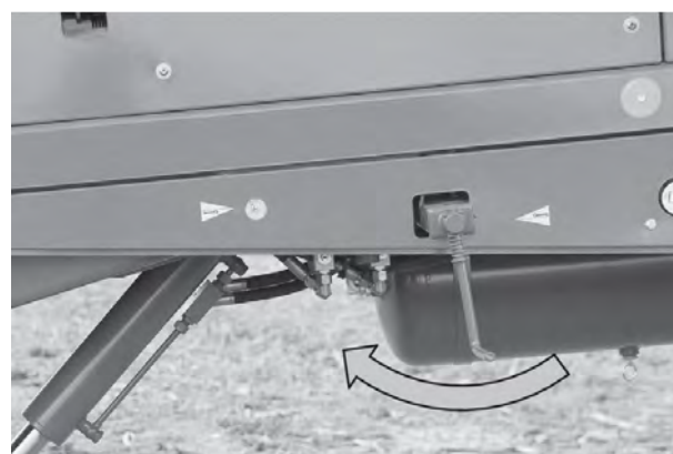
Fig. 49: Parkeringsbremse (hydraulisk bremsesystem)
