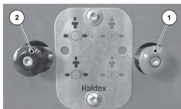
Fig. 48: Parkeringsbremse (pneumatisk bremsesystem)
