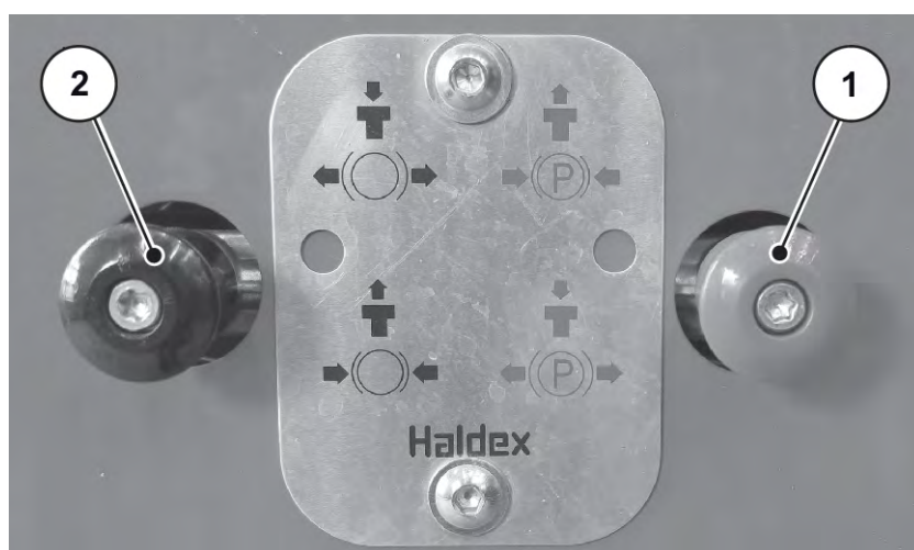
Fig. 44: Trækning af manuel parkeringsbremse
