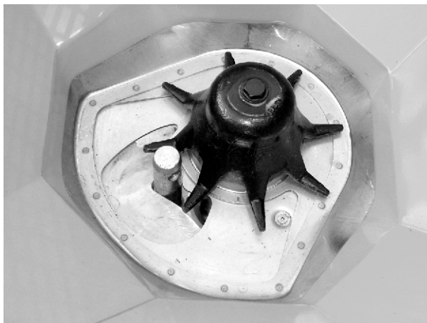
Fig. 83: Trækstangbolt i doseringsåbningen
