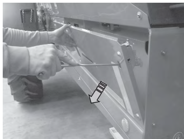
Fig. 50: Nedklapning af sideafdækningen
