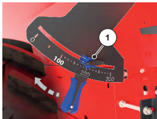
Рис. 37: Градуированная дуга открытия заслонки устройства предварительного дозирования
