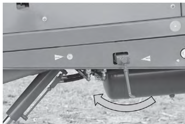
Рис. 49: Стояночный тормоз (тормозная система с гидравлическим приводом)
