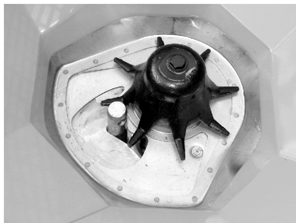
Рис. 95: Болт нижней тяги в дозировочном отверстии
