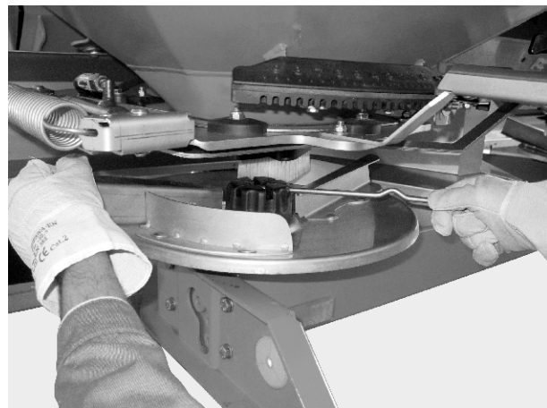
Рис. 42: Отвинчивание колпачковой гайки
