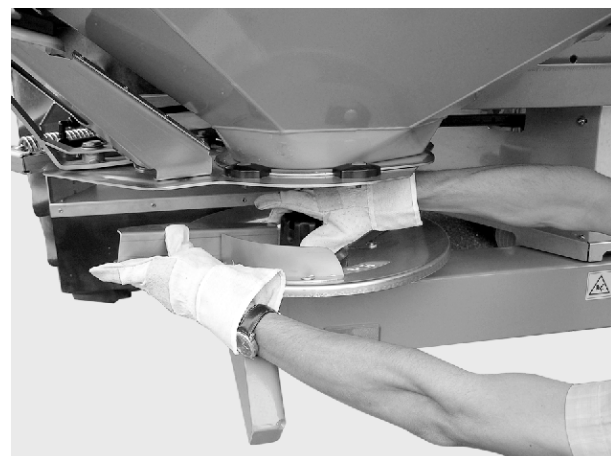
Рис. 43: Откручивание колпачковой гайки
