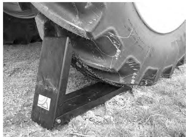
*Fig. 51: Positionner une cale*
