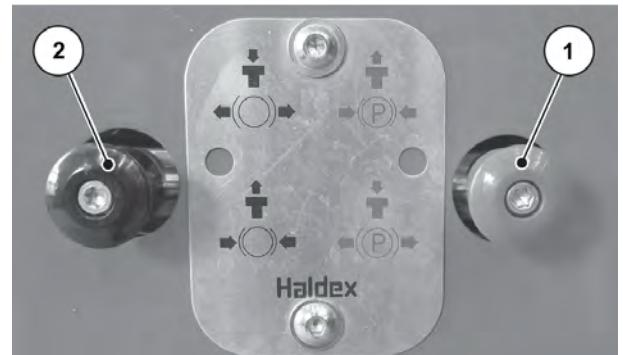
Fig. 48: Frein de stationnement (système de freinage pneumatique)
