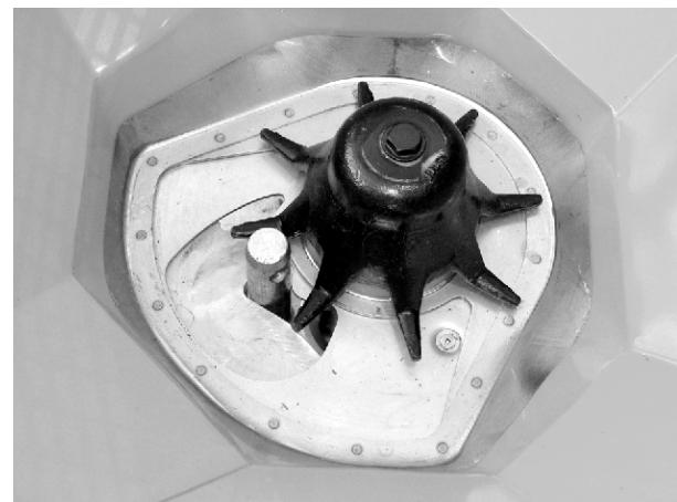
*Fig. 95: Axe de bras inférieur d'attelage dans la trappe*
