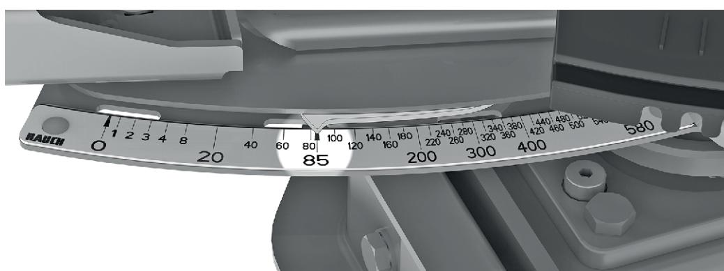
Fig. 45: Échelle graduée indiquant la dose d'épandage
