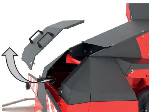
*Fig. 68: Capot du dispositif d'épandage*
