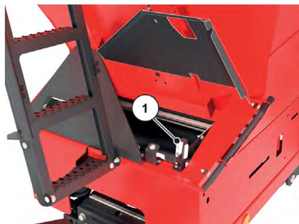
*Fig. 34: Trappe de nettoyage en position fermée, dans le sens d'avancement en avant*
