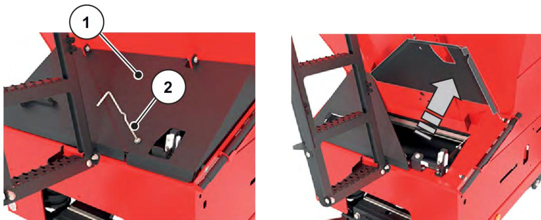
*Fig. 67: Ouvrir le capot avant*
