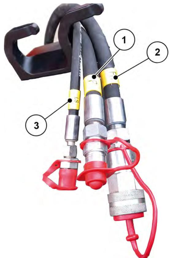
Fig. 24: Identification des flexibles hydrauliques
