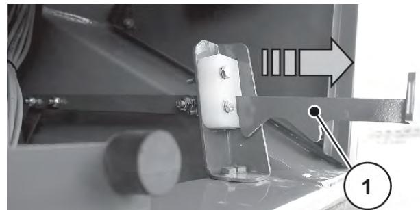
Fig. 58: Levier de la trappe de nettoyage
