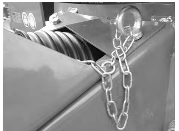
*Fig. 22: Fixer la chaîne de maintien*
