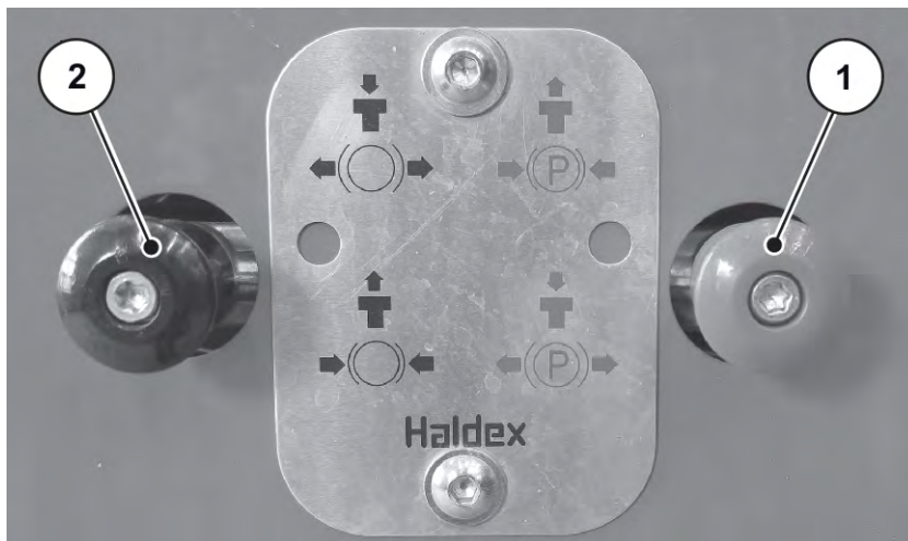
Fig. 28: Desserrer le frein de stationnement
