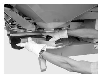
Fig. 41: Unscrew the cap nut
