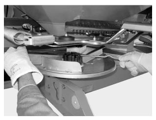
Fig. 40: Loosen the cap nut
