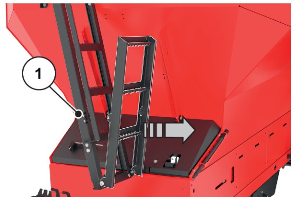
Ilust. 31: Extraer la parte inferior de la escalera
