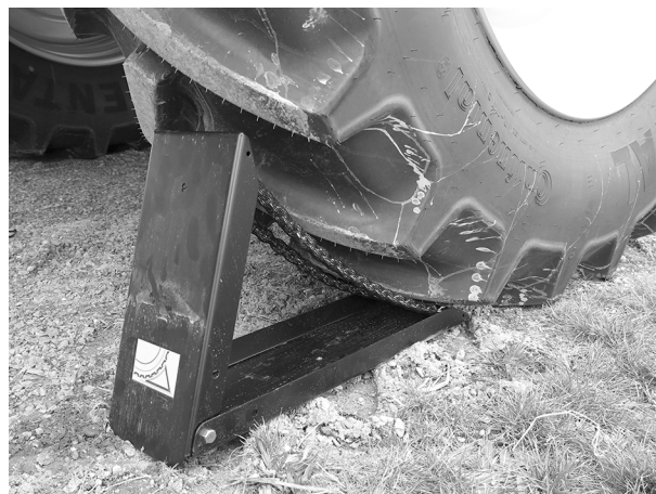
Ilust. 46: Colocación de la cuña
